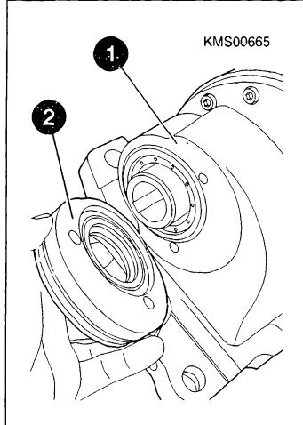
ASSEMBLING REDUCTION GEAR (TYPE TF 0 001 613 ...)
